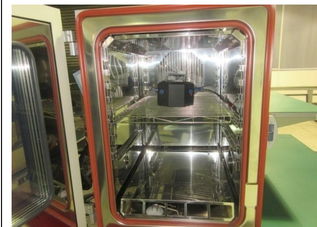
图7. 低温存储试验布置图
