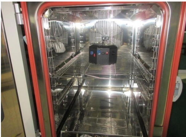
图17. 高温存储试验布置图
