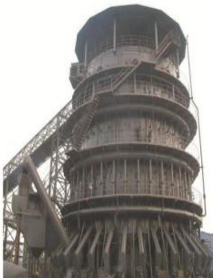
铁含碳量2%以上,钢含碳量低于2%,称钢铁冶炼,高炉炼铁球团竖炉,在利用铁矿粉和石灰、皂土、焦粉等添加剂混合造球时,在竖炉中进行焙烧的过程产生烟气,传统工艺烟气大多采用采用袋式除尘器或电除尘器或者旋风除尘器和多管除尘器,这些设备都达不到国家排放标准,不宜使用。球团竖炉烟气脱硫脱硝,尚未采取有效的治理措施。
